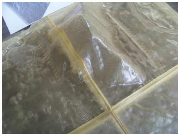
Dettaglio dell'accoppiamento tra i vari riquadri. Grazie all'estrema precisione di stampa non si sono verificati particolari problemi.
