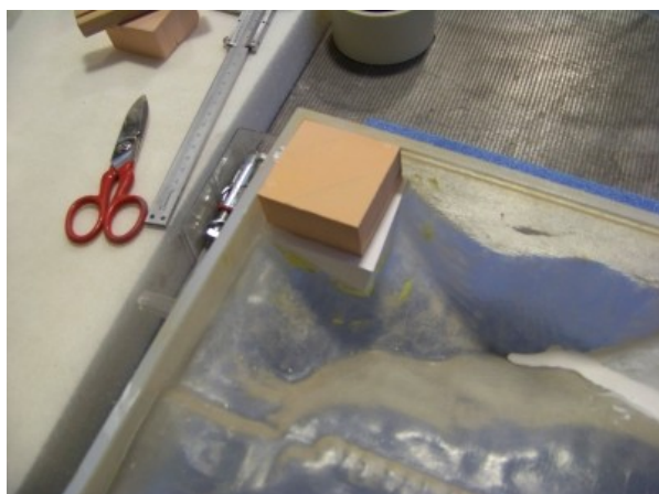
Nei volumi interni cavi delle piastre sono stati colati supporti in resina poliuretanica per facilitarne la posa sul piano
