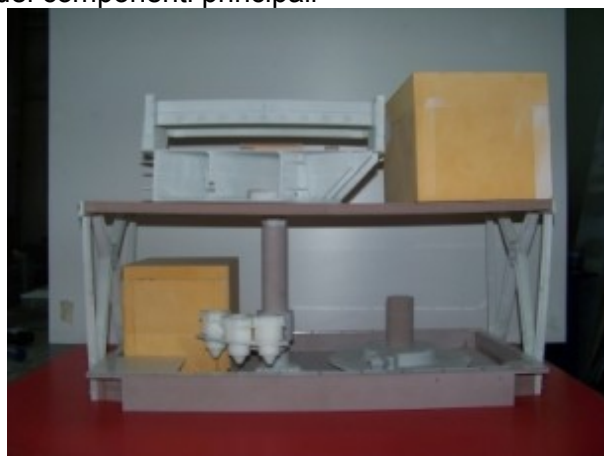
Premontaggio per la verifica dell'accoppiamento dei componenti principali
