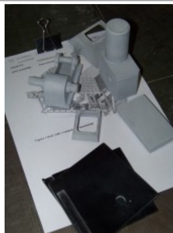
Componenti “Milling Station” in PA sinterizzato
