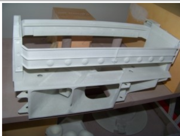
Particolare “CSTM” - sinterizzazione in PA
